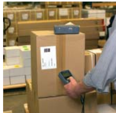
Scannung mit dem Intermec-Trakker 2415 im Warenausgang
