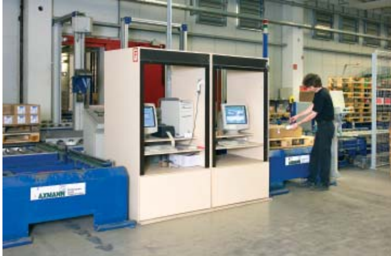
Dynamische Kommissionierung nach dem Prinzip „Ware zum Mann“
