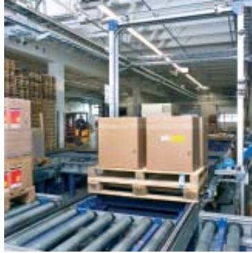
Automatischer Weitertransport in das Hochregallager
